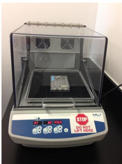
*Ilustración 6 - Ejecución ensayo de permeabilidad bajo condiciones fisiológicas.*
