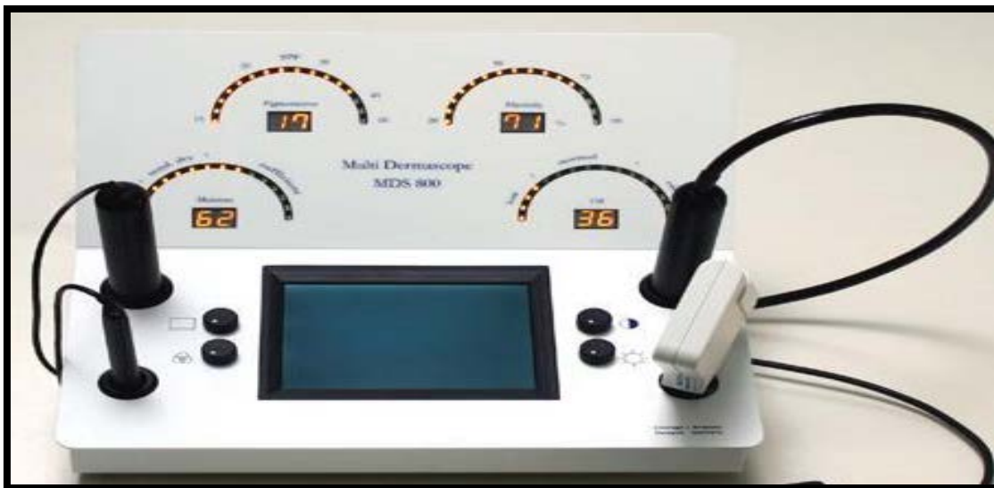
Figura 9. Equipo Multidermascop MDS 800 (Courage-Khazaka Electronic GmbH). Instrumento que permite tomar las medidas de % elasticidad bruta y % Hidratación. Fuente: Elaborado por Lina María Muñoz.
